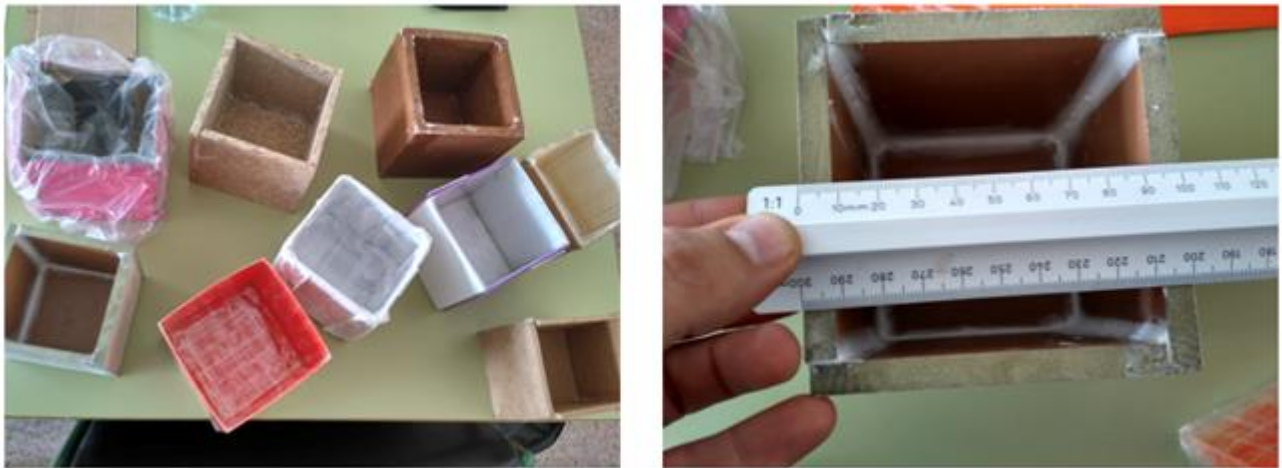
Figura 4. a (esquerra) Cubs realitzats per l'alumnat amb diferents materials. b (dreta) Cub en el qual no es va tenir en compte el grossor de les parets.
